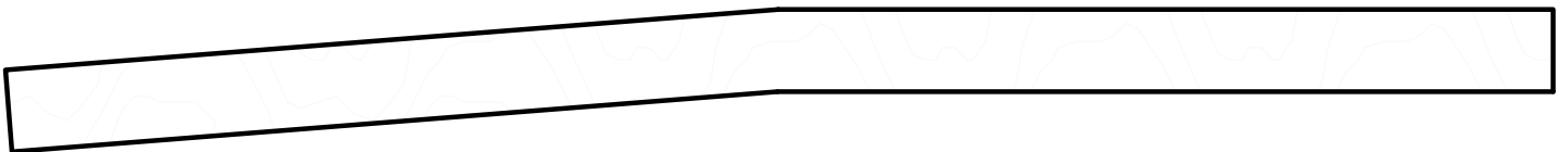
Bayoneta o refuerzo central (Madera contrachapada) 3-5mm
